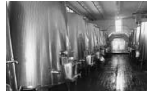
Die grossen Stahltanks für die Gärung
